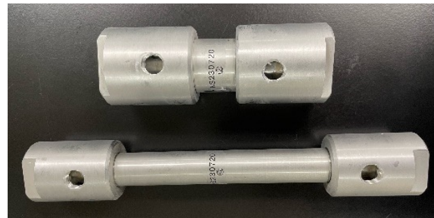
KMF製ベンチ用モジュール 有効膜面積: 1,000 cm 2
